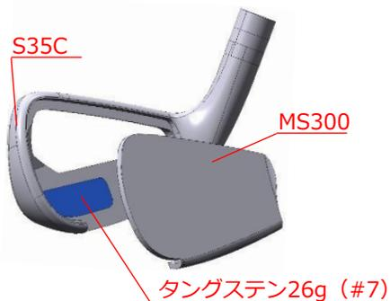
タングステンウエイトを配置することで、重心距離が長く(+1.0mm)、深重心化(+0.6mm)となり、高打出しと高い直進性を実現。※TW747 Vx比
